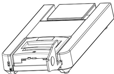
Fixer le coffret sur le mur en prenant soin de laisser accessible le système de fermeture du capot ainsi que le système de réarmement du DM.
